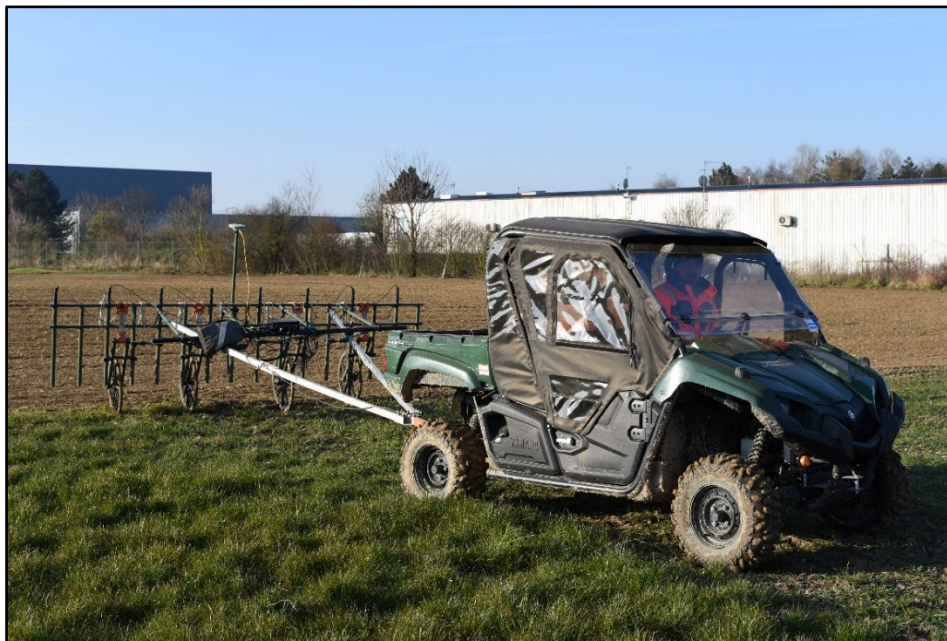
Figure 5 : Mise en œuvre du magnétomètre 8 sondes tracté par un quad (Source : Geomines)
